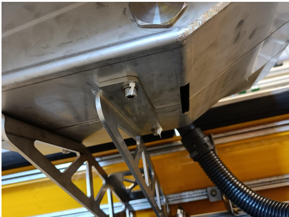
Figur 29 - Skyddande robust inkapsling samt skyddsslang för kablage, sett underifrån
