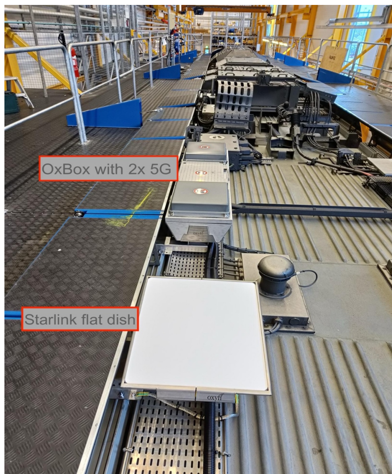
Figur 26 – Översiktsbild, installation på Coradia fordonstak, OxBox + Starlink
