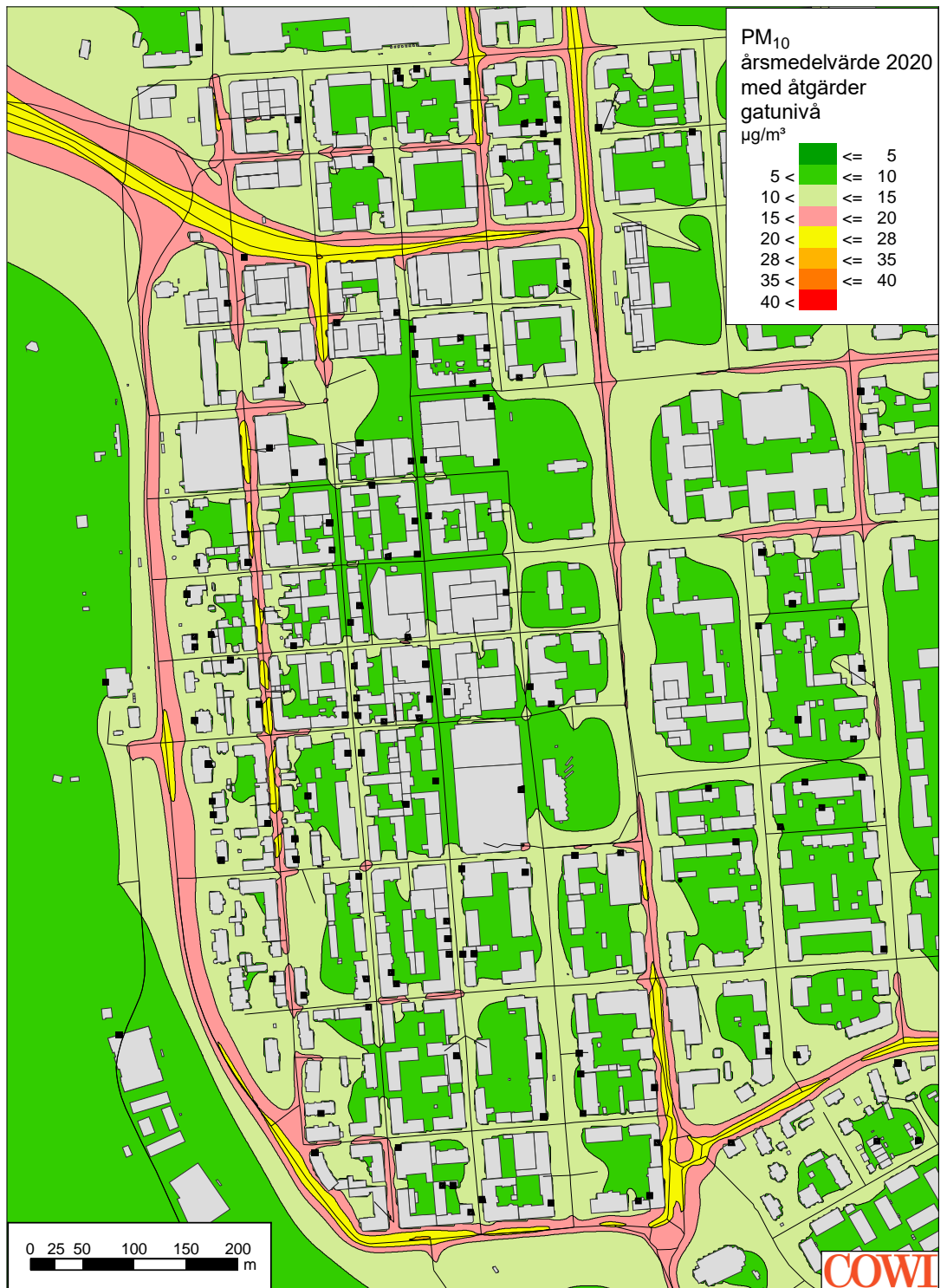
Figur 16 Årsmedelvärde av partiklar, PM 10 , med damningsdämpande åtgärder. Spridningsberäknat för år 2020 med Miskam för det mindre beräkningsområdet.
